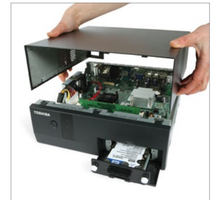
GEREEDSCHAPSLOZE TOEGANG TOT INTERNE ONDERDELEN - Met inbegrip van snelle HDD verwijdering uit het frontpaneel
